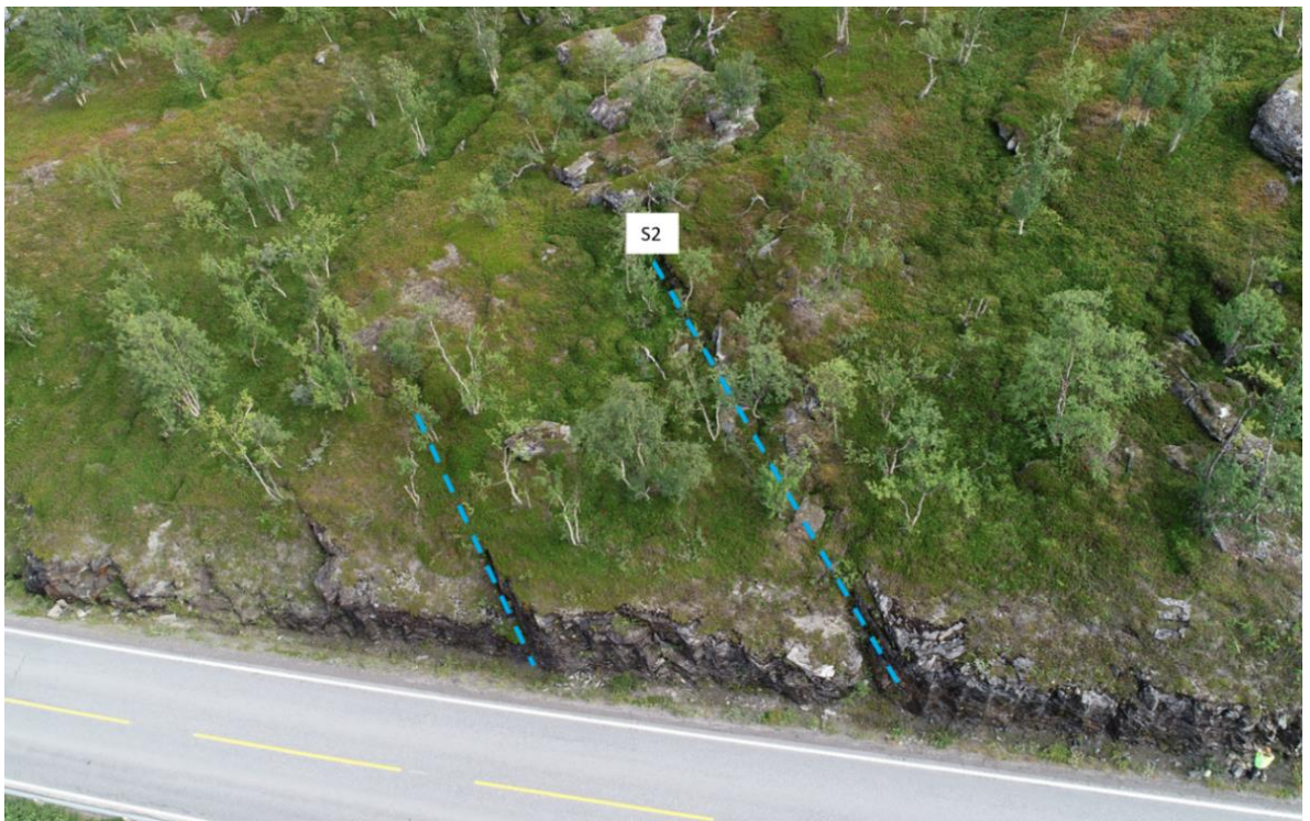
Figur 15: Sprekesett S2 observeres tydelig som lineamenter i terrenget fra dronebilder ved Lillefossen.
