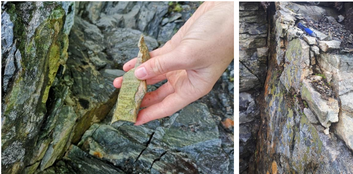
Figur 17: Funn av et grønnlig belegg langs sprekkeflate, tilhørende sprekkesettet S2. Belegget kjentes glatt.
